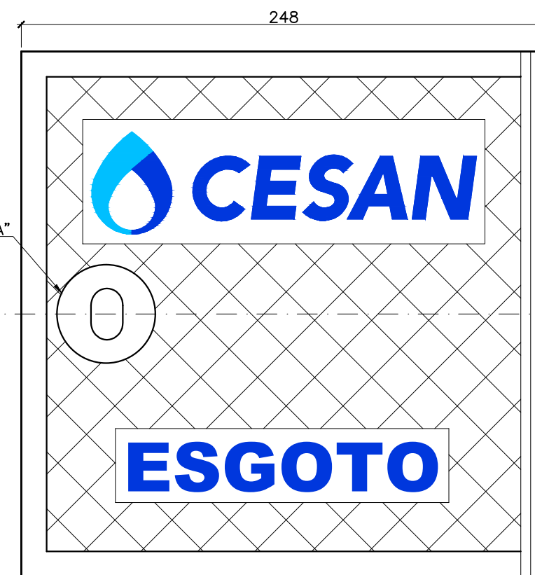
TAMPA CAIXA DE LIGAÇÃO ESC.:1/25
