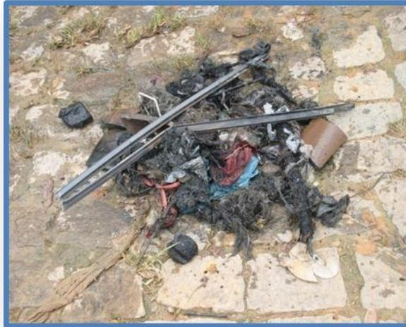
Lixo retirado de uma rede coletora de esgoto.
