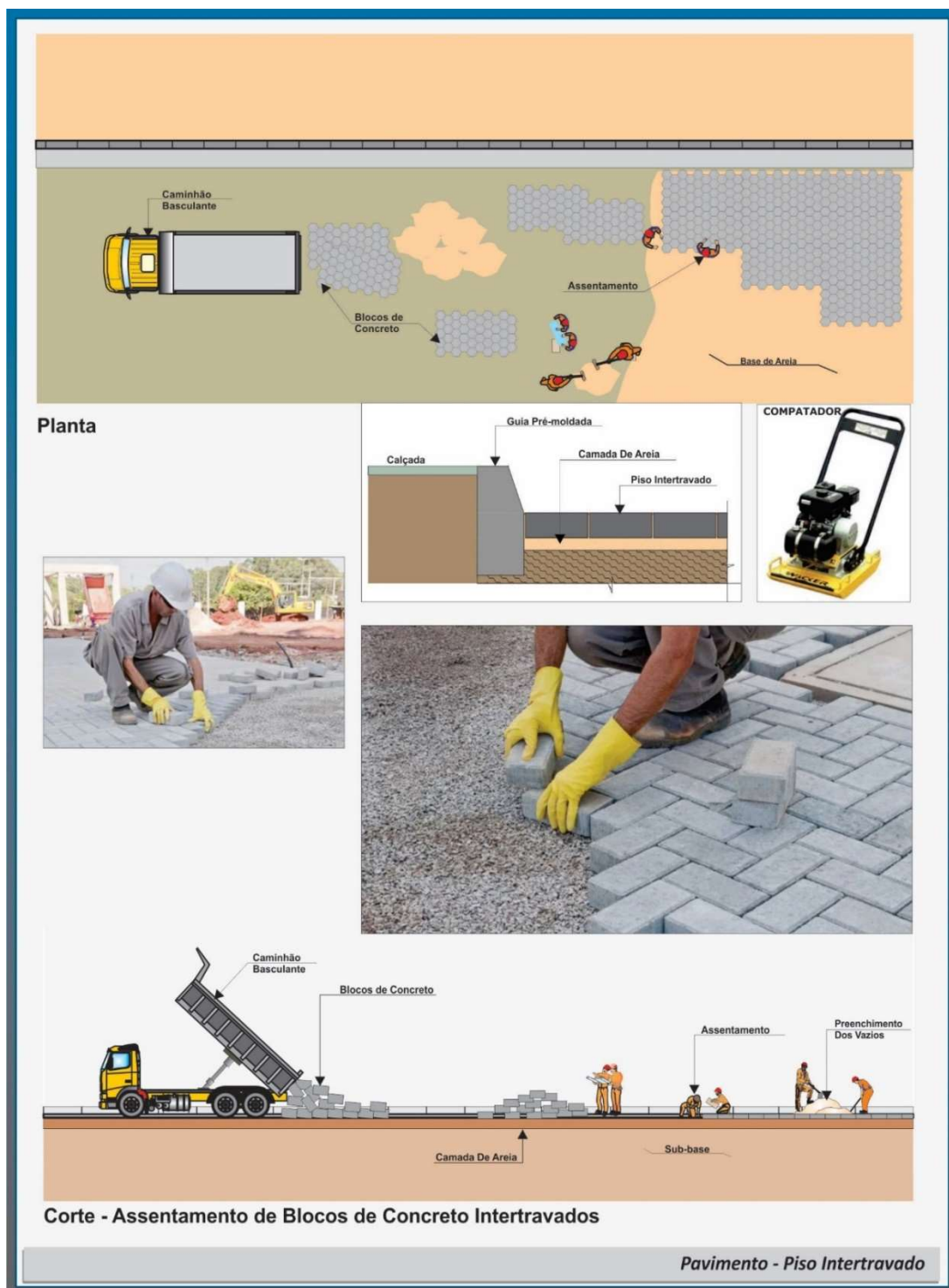
Figura 4 - Assentamento de blocos intertravados de concreto
