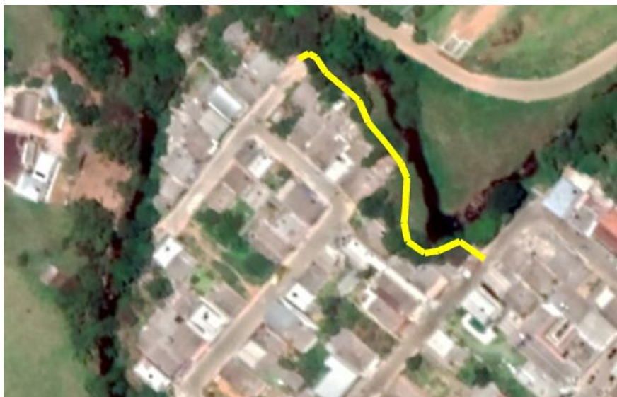
Figura 23 - Trecho 1: composto por 113 m de rede enterrada e 52 m de rede exposta
