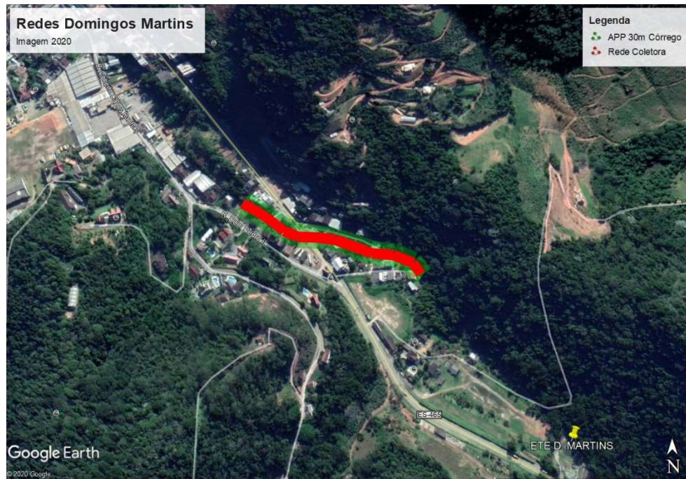
Figura 27 – Localização 7 de 367 m de Rede Coletora Beira- Rio enterrado na Sub-bacia 03.
