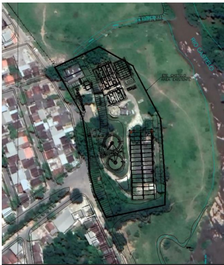
Figura 25 – Layout previsto para ampliação da ETE
