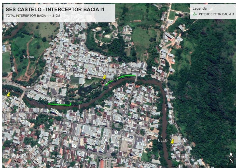
Figura 54 – Interceptora Bacia I1– 116 m enterrado e 196 aéreo.
