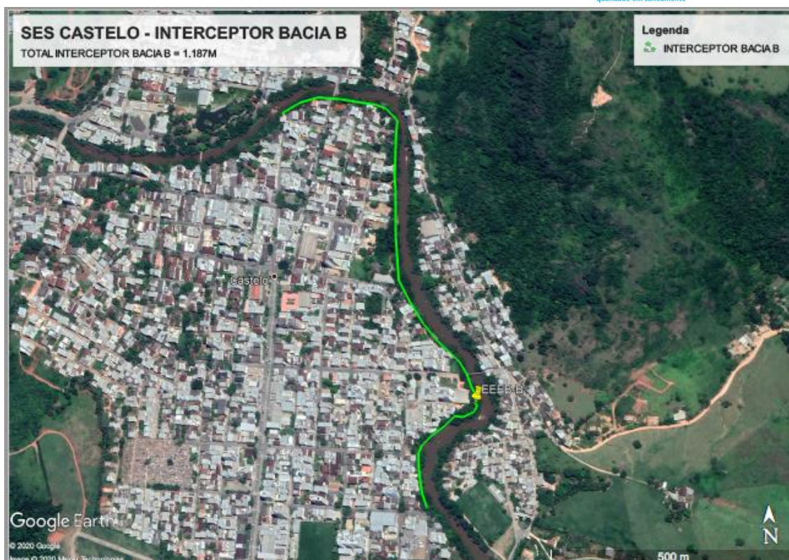
Figura 42 – Interceptora Bacia B - 799 m enterrado e 388 aéreo.
