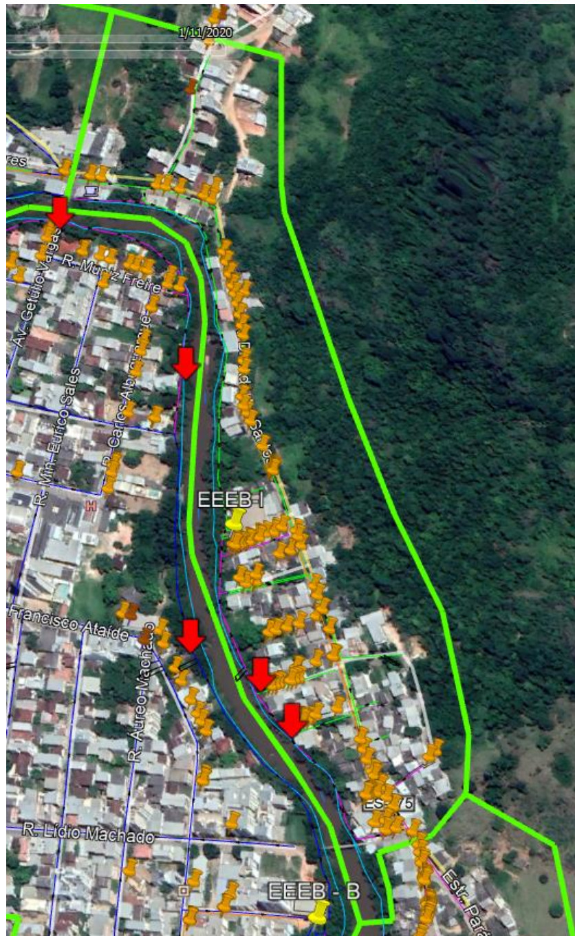
Figura 51 – Pontos de extravasão da Bacia I e imóveis sem coleta.
