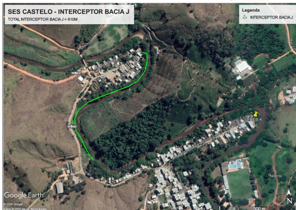
Figura 56 – Interceptora Bacia J – 379 m enterrado e 231 aéreo.
