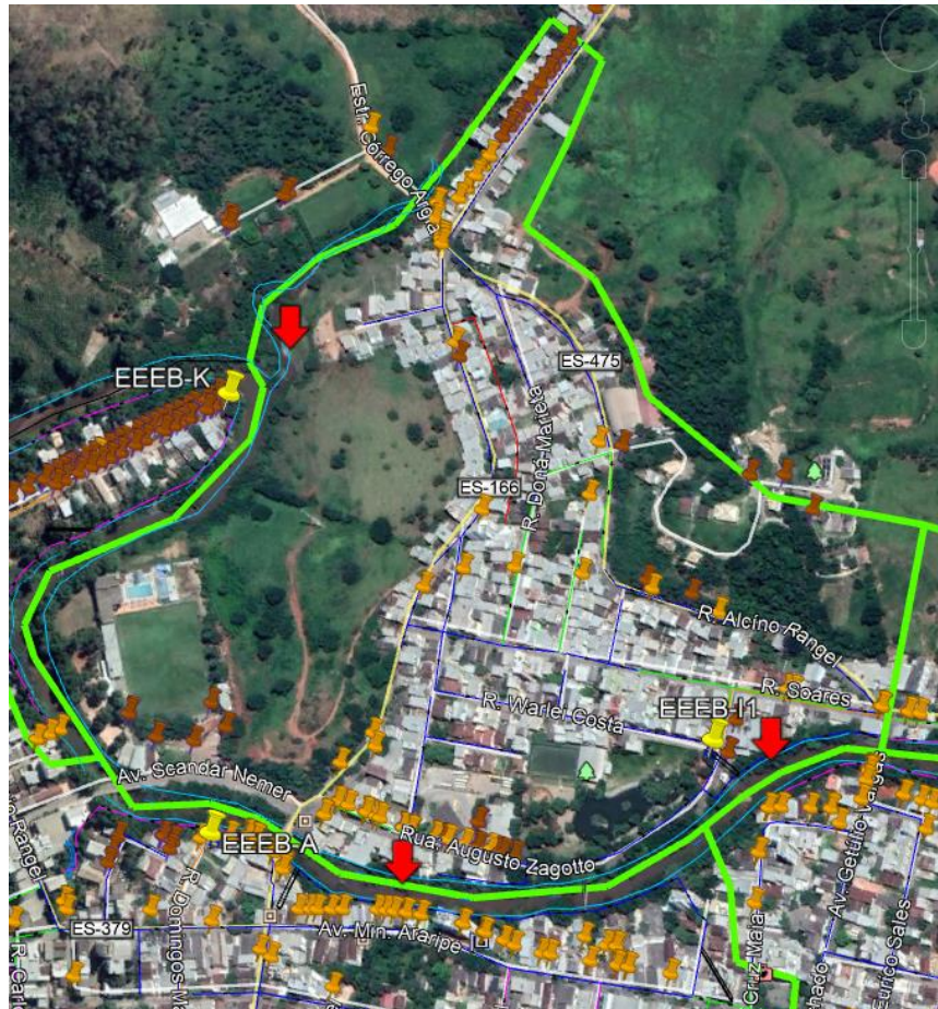
Figura 53 – Pontos de extravasão da Bacia I1 e imóveis sem coleta.
