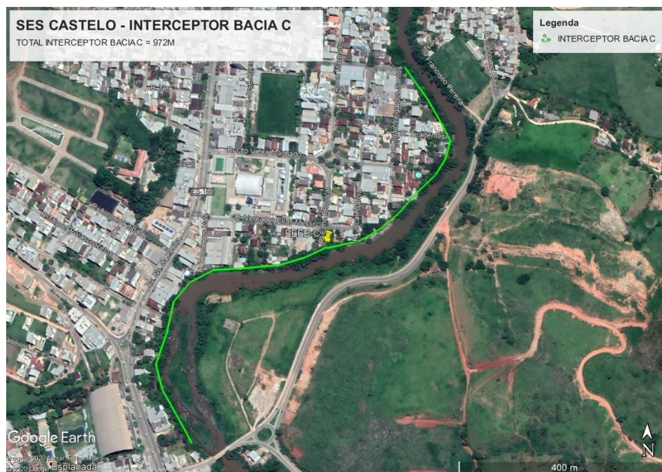
Figura 44 – Interceptora Bacia C – 715 m enterrado e 257 aéreo.
