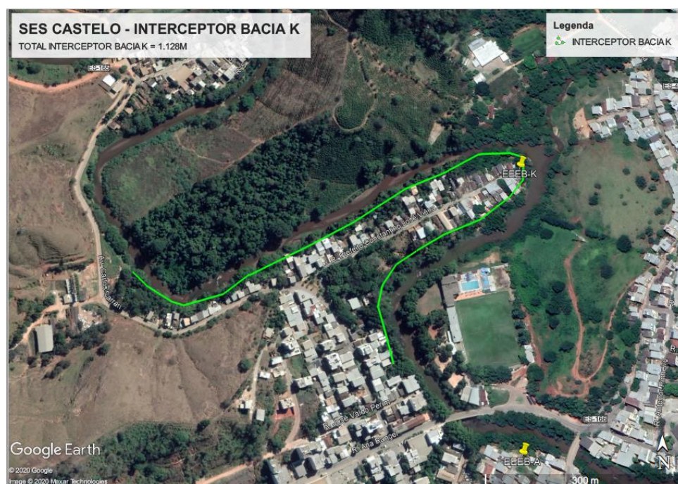
Figura 57 – Interceptora Bacia K - 984 m enterrado e 144 aéreo.
