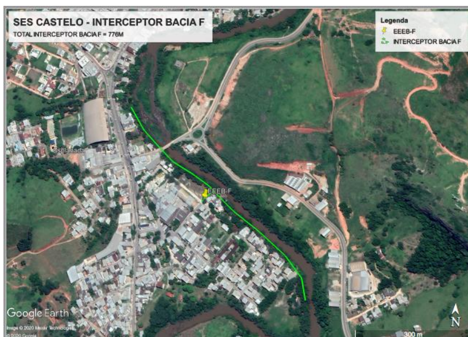
Figura 48 – Interceptora Bacia F – 429 m enterrado e 347 aéreo.
