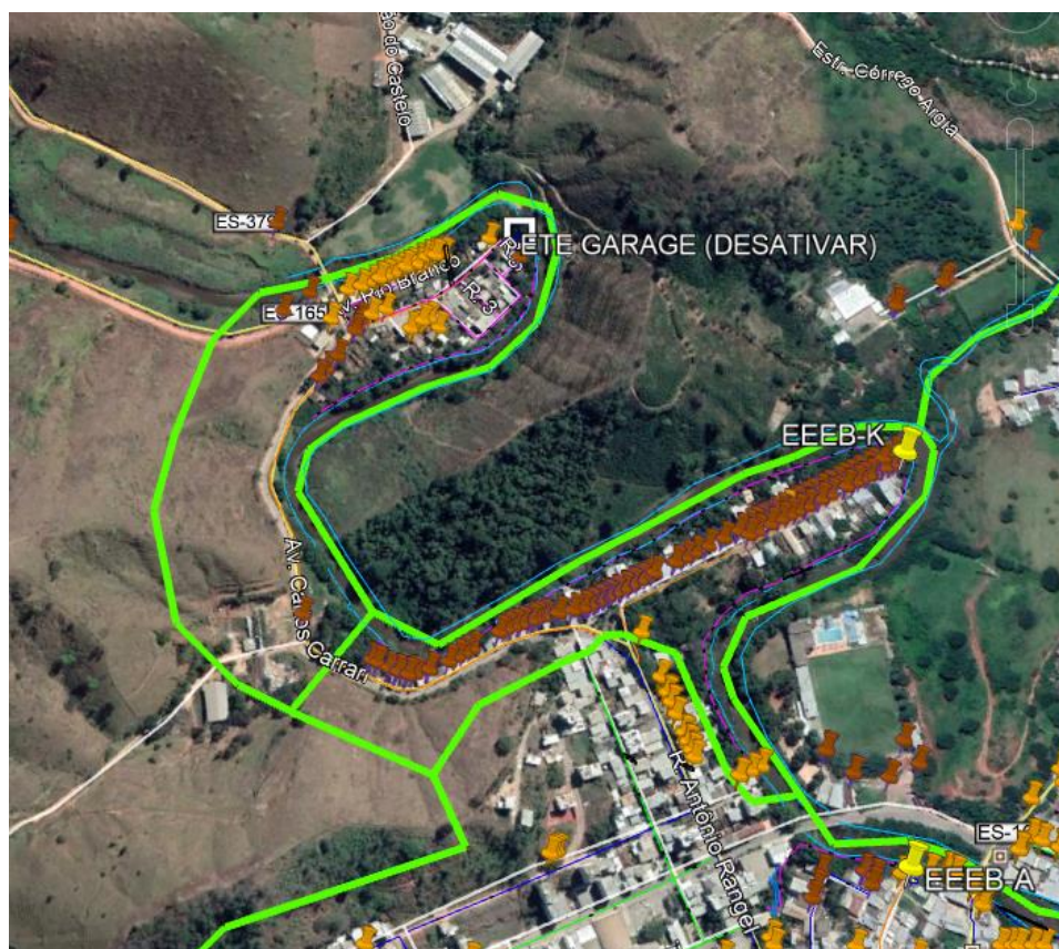
Figura 55 – Pontos de extravasão das Bacias J e K e imóveis sem coleta.
