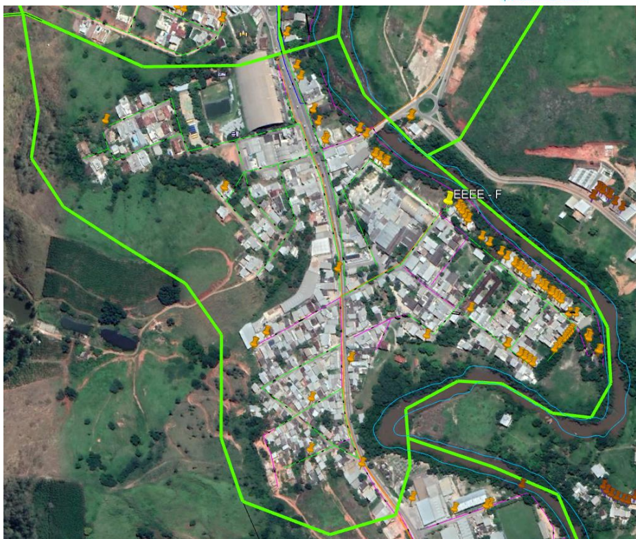
Figura 47 – Pontos de extravasão da Bacia F e imóveis sem coleta.
