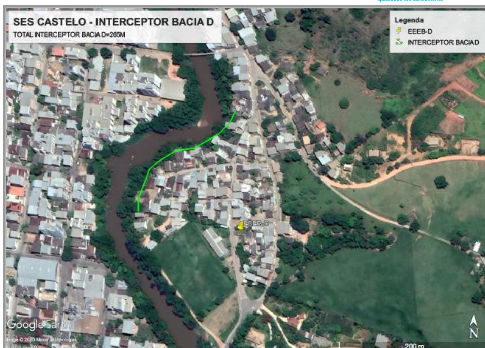
Figura 46 – Interceptora Bacia D – 199 m enterrado e 66 aéreo.
