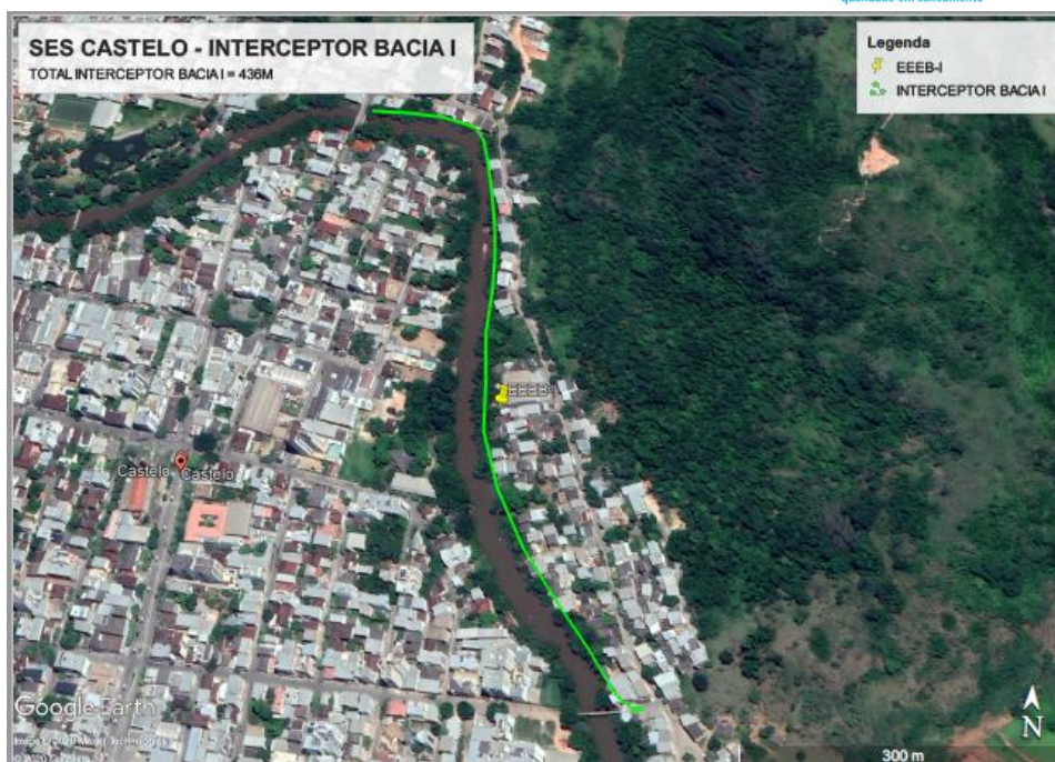
Figura 52 – Interceptora Bacia I– 296 m enterrado e 140 aéreo.
