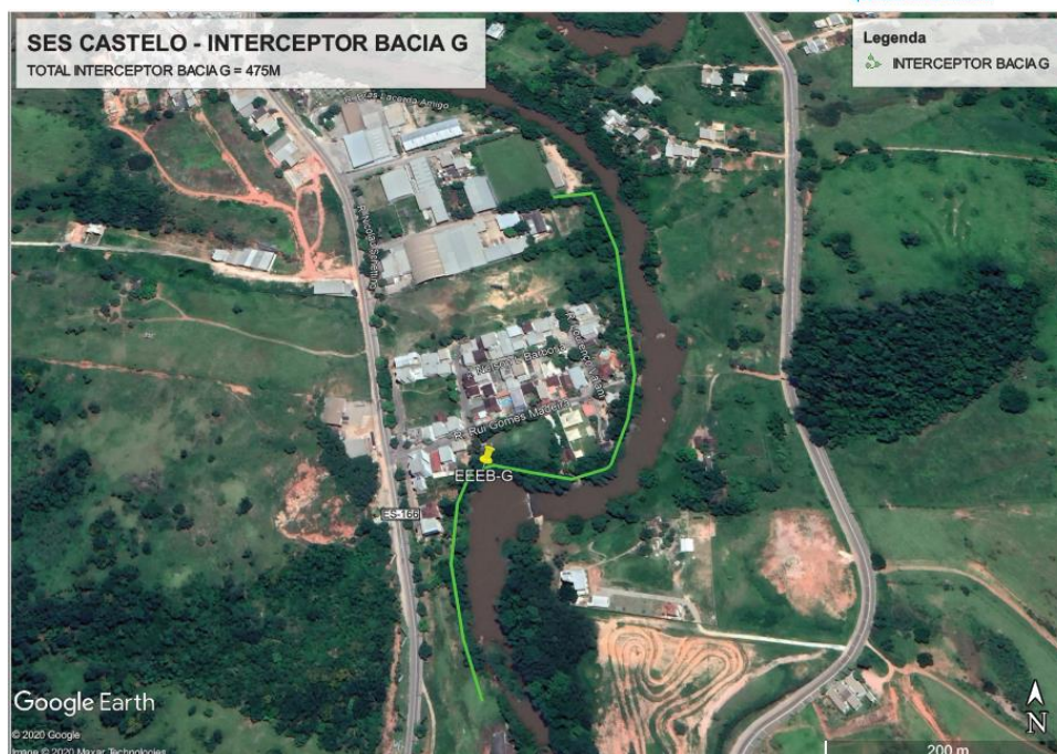
Figura 50 – Interceptora Bacia G – 476 m enterrado.
