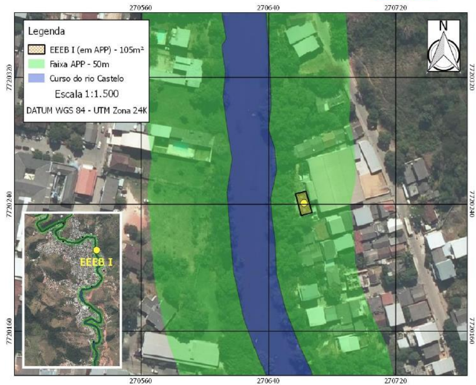
Figura 71 - Interferência da EEEB - I em área de APP.
