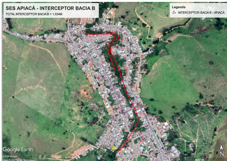
Figura 24 – Interceptora Bacia B - 1059 m enterrado e 475 m aéreo.
