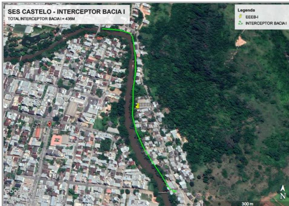
**Figura 52 – Interceptora Bacia I– 296 m enterrado e 140 aéreo.**
