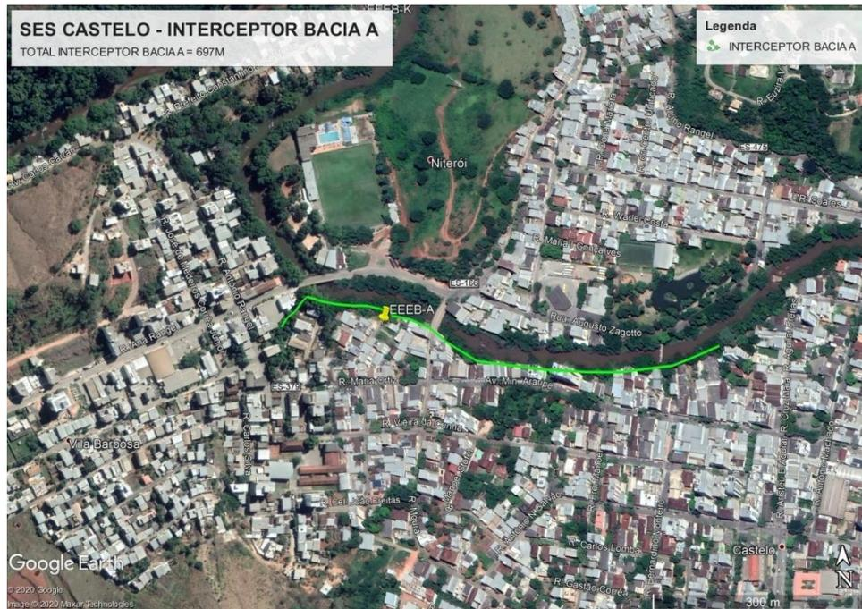
**Figura 40 – Interceptora Bacia A - 650 m enterrado e 47 aéreo.**
