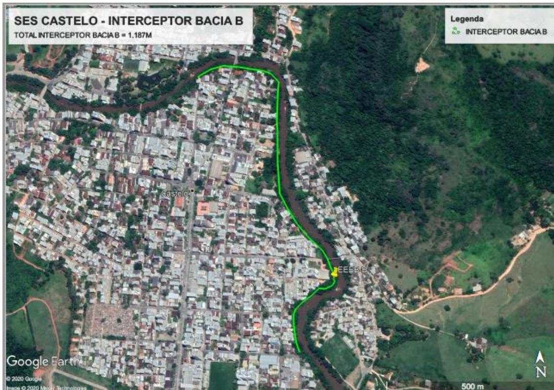
**Figura 42 – Interceptora Bacia B - 799 m enterrado e 388 aéreo.**
