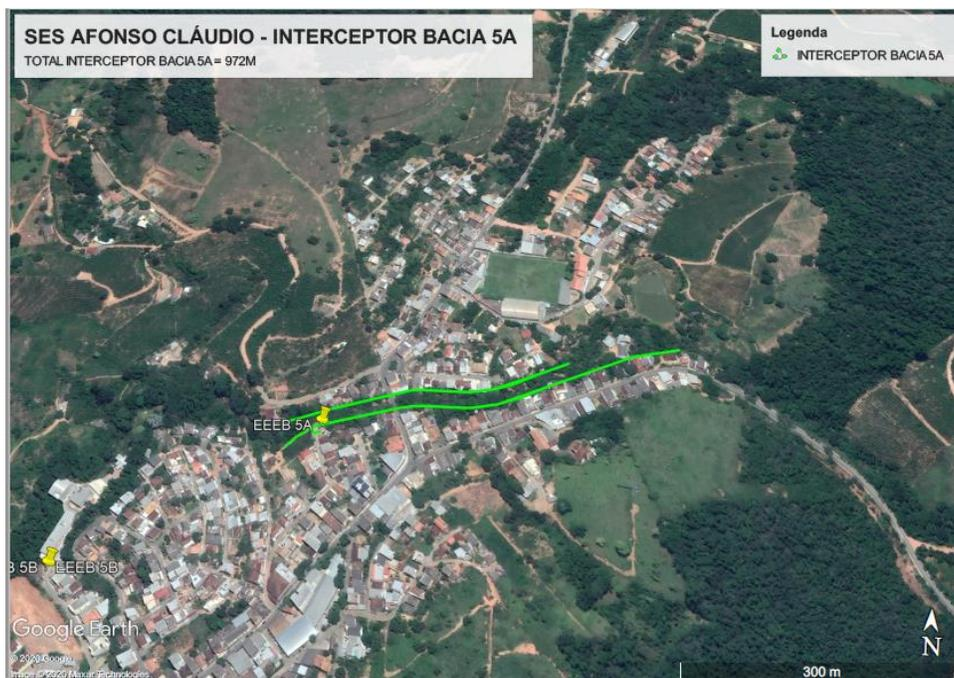
Figura 15 – Interceptora Bacia 5A - 577 m enterrado e 395 aéreo.
