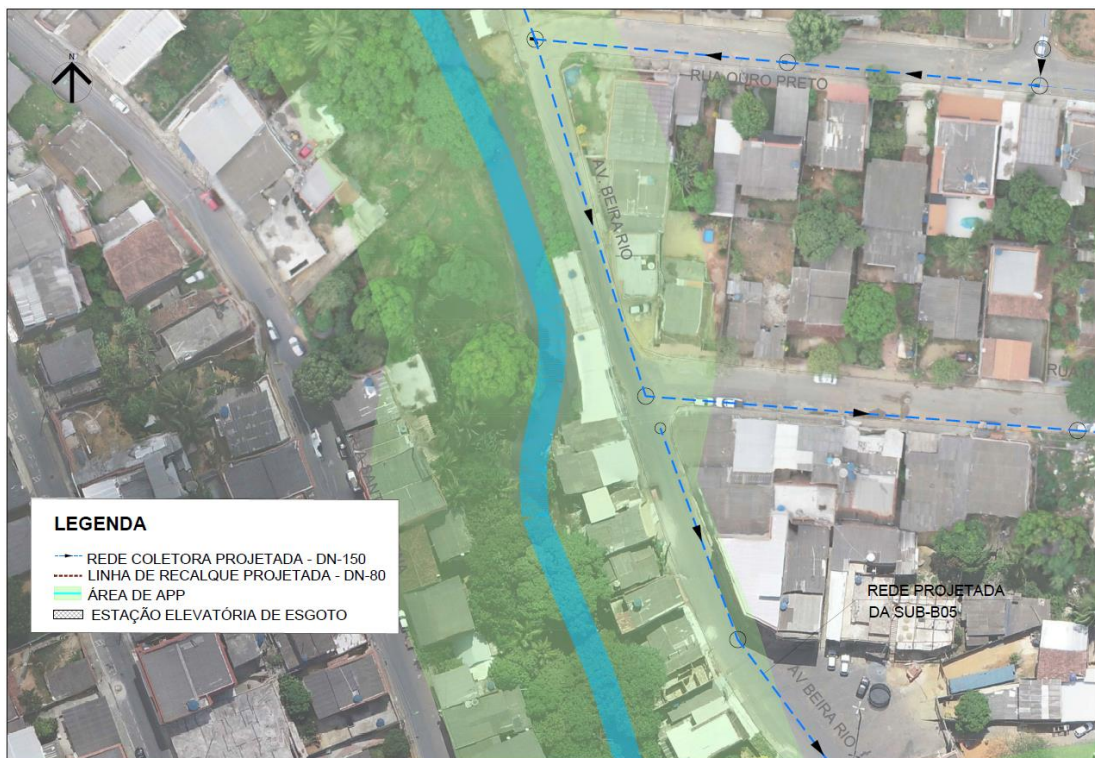
Figura 9 - Trecho entre os PVs 16 até 38, 38 até 40 e 72 até 73, em 2019, mostrando a rede projetada em APP.
