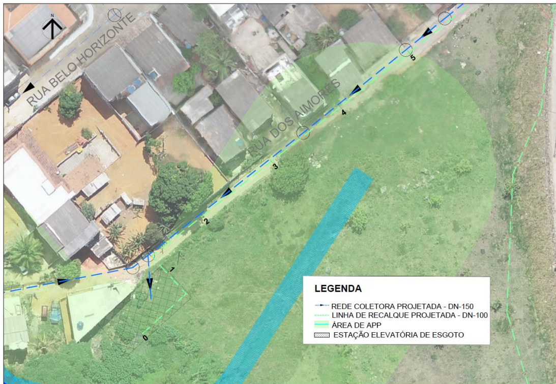
Figura 19 - Trecho 2 entre as estacas 0 e 5+ 0,43 m, passando em área de APP, em 2019.
