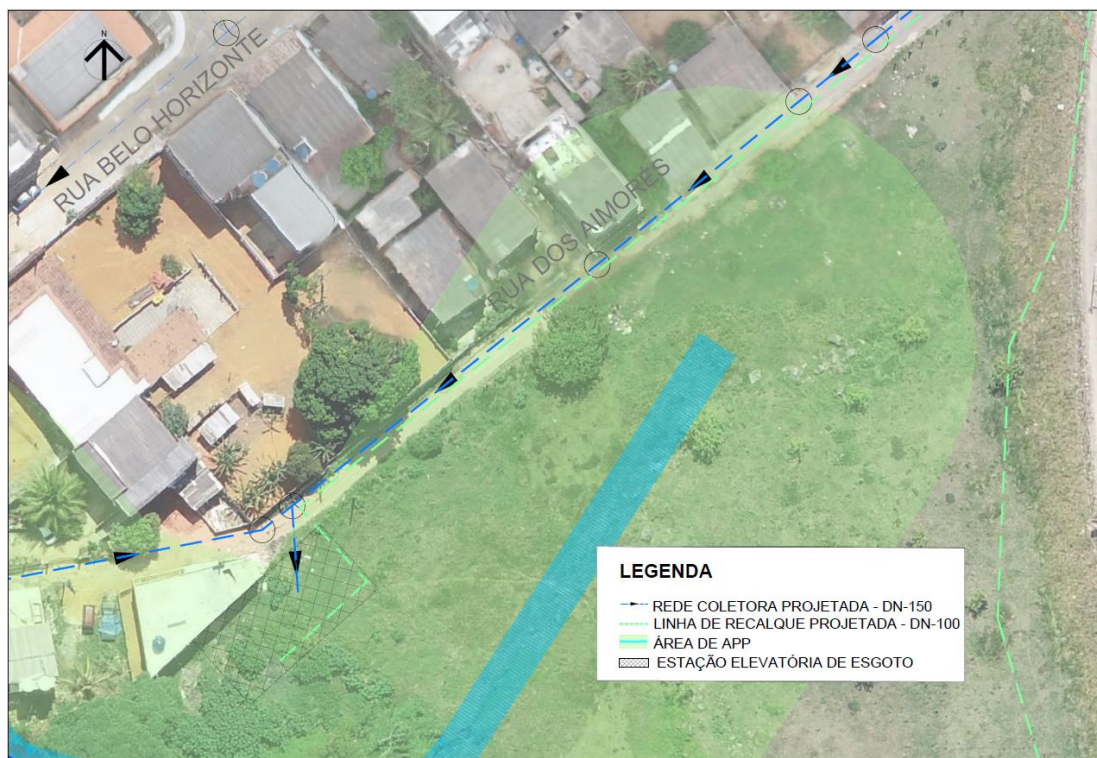
Figura 15 - Trecho entre os PVs 78 até 86, em 2019, mostrando a rede projetada em APP.
