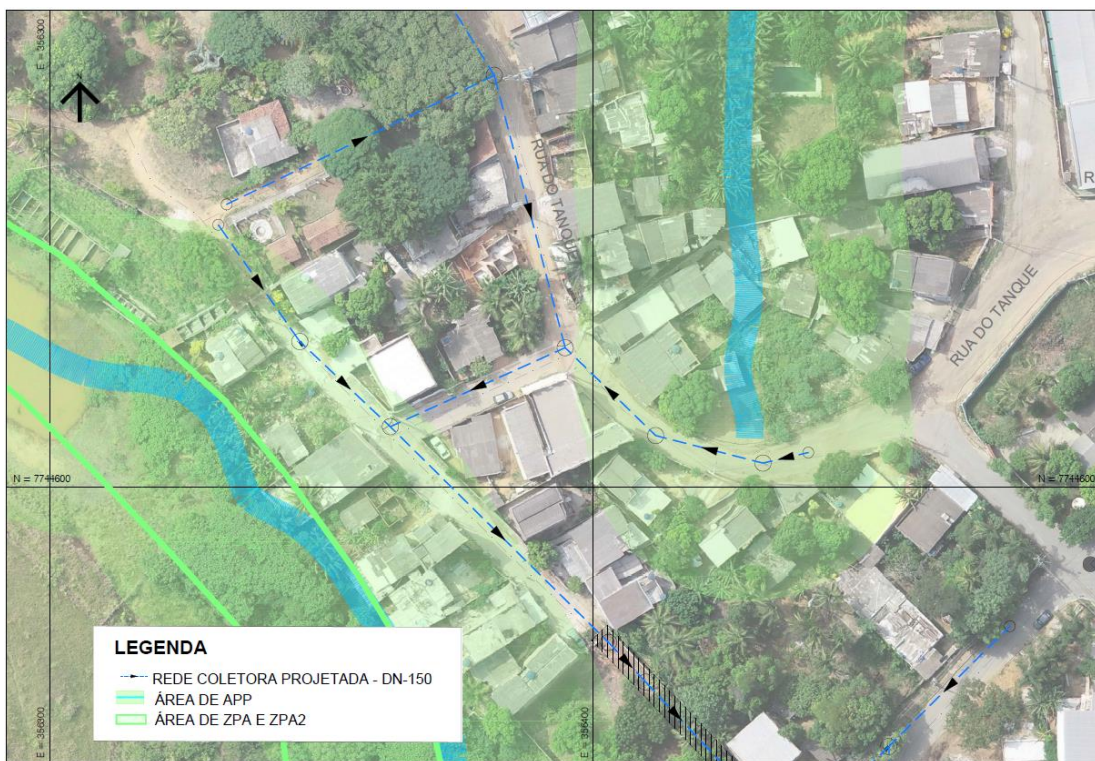
Figura 3 - Trecho entre os PVs 11 até 16 e 10 até 13 em 2019, mostrando a rede projetada em APP.
