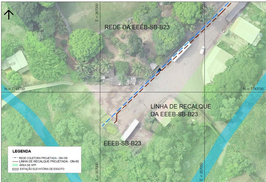
**Figura 3 - Trecho entre os PVs 53 até 54, em 2019, mostrando a rede projetada em APP.**
