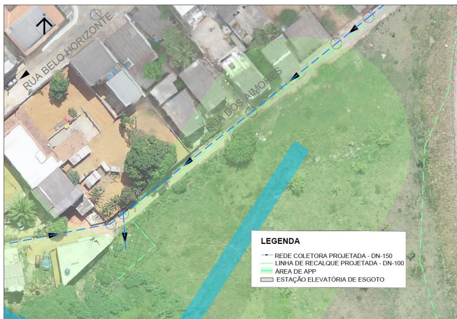
Figura 2.1-16: Trecho entre os PVs 78 até 86, em 2019, mostrando a rede projetada em APP.
