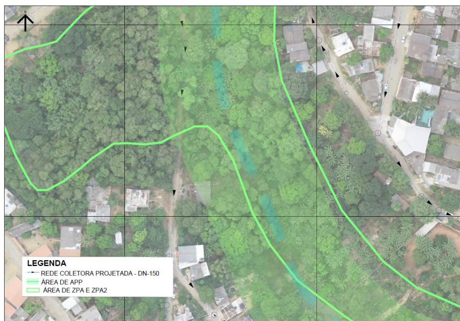
Figura 2.1-82: Trecho entre os PVs 118 até 130, em 2019, mostrando a rede projetada em APP.
