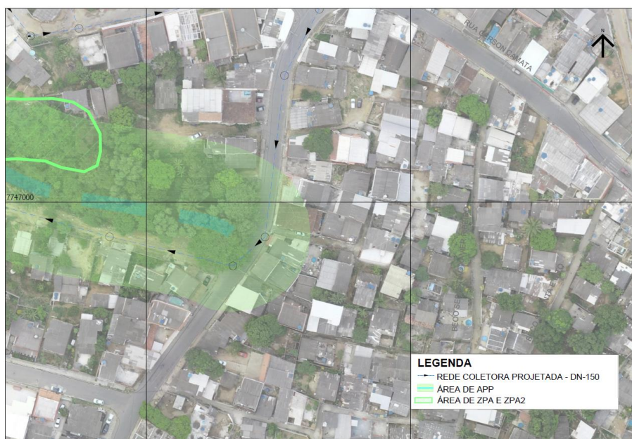
Figura 2.1-85: Trecho entre os PVs 165 até 169, em 2019, mostrando a rede projetada em APP.
