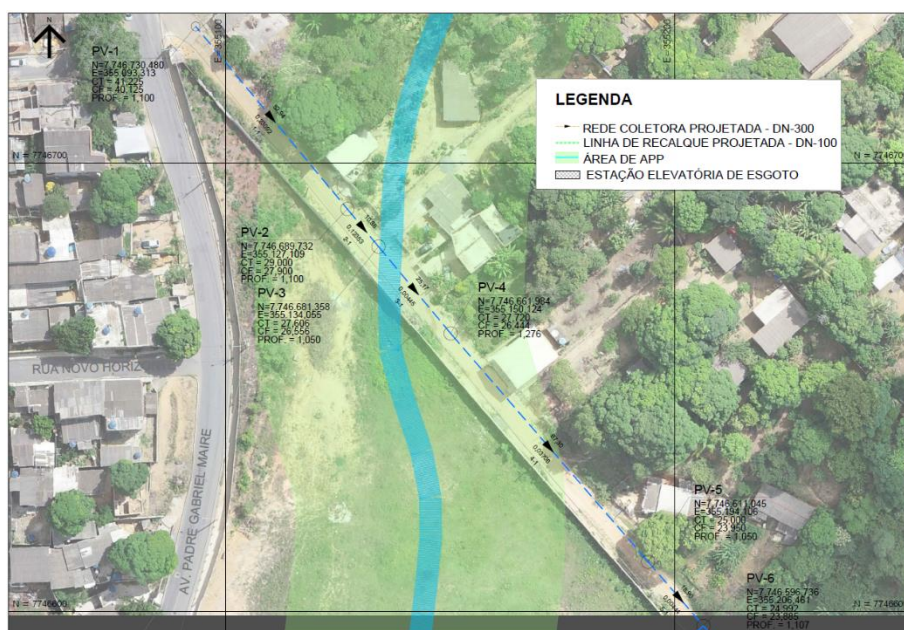
Figura 2.1-77: Trecho entre PVs 01 até 05, mostrando a rede projetada em APP, em 2019.
