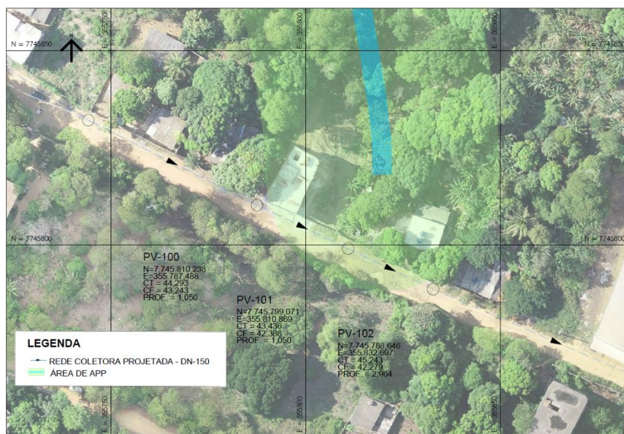
Figura 2.1-108: Trecho entre PVs 100 até 102 mostrando a rede projetada em APP, em 2019.
