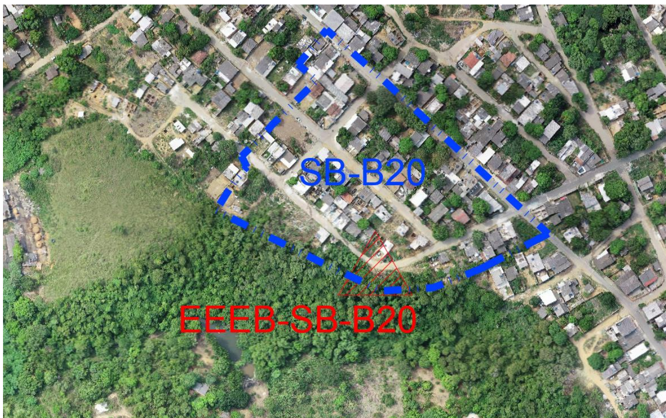
Figura 44 - Limites da Sub-bacia SB-B20, mostrando a estação elevatória de esgoto bruto EEEB-SB-B20.
