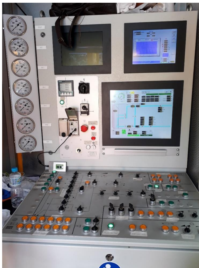
Figura 91 – Equipamento de monitoração remota da cravação.
