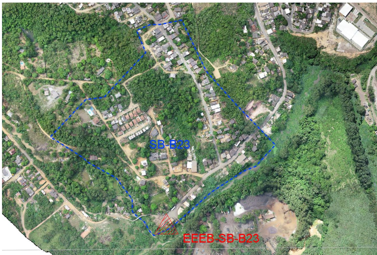
Figura 46 - Limites da Sub-bacia SB-B23, mostrando a estação elevatória de esgoto bruto EEEB-SB-B23.
