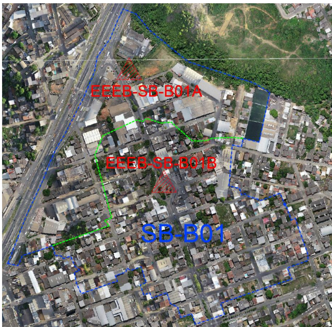
Figura 29 - Limites da Sub-bacia SB-B01, mostrando as estações elevatórias de esgoto bruto EEEB-SB-B01A e EEEB-SB-B01B.
