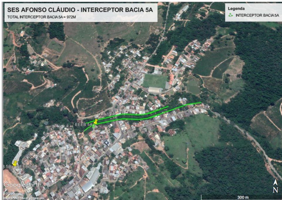
Figura 28 – Interceptora Bacia 5A - 577 m enterrado e 395 aéreo.
