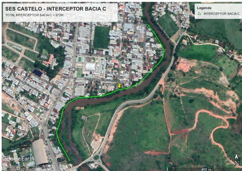
**Figura 44 – Interceptora Bacia C – 715 m enterrado e 257 aéreo.**
