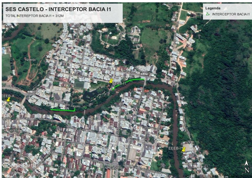
**Figura 54 – Interceptora Bacia I1– 116 m enterrado e 196 aéreo.**
