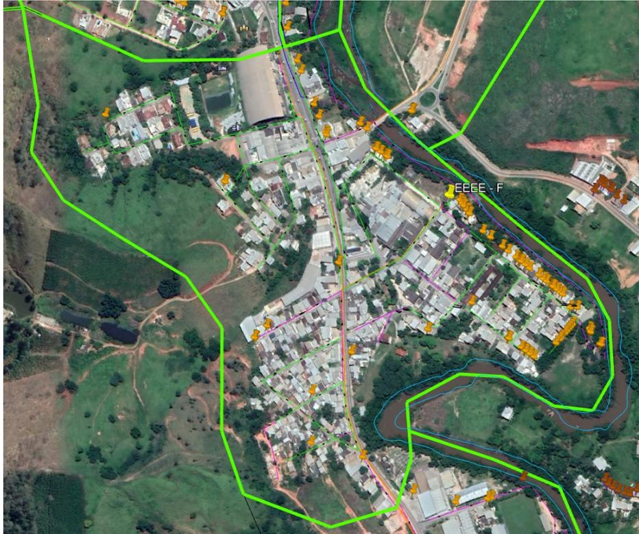
**Figura 47 – Pontos de extravasão da Bacia F e imóveis sem coleta.**
