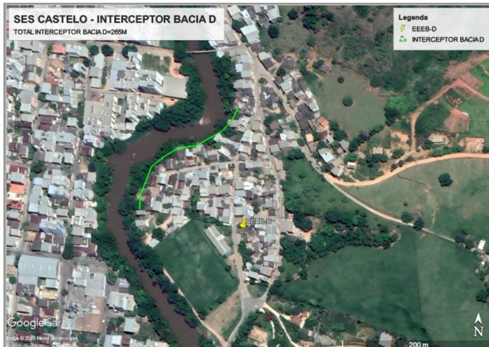
**Figura 46 – Interceptora Bacia D – 199 m enterrado e 66 aéreo.**
