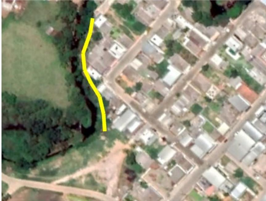
**Figura 24 - Trecho 2: composta de 69 m de rede enterrada e 65 m de rede exposta.**
