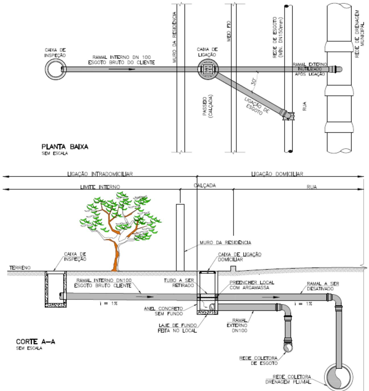
**Figura 21 - Planta e corte da ligação domiciliar.**
