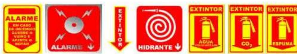
**Figura 10 – Exemplo de Sinalização de Equipamentos de Combate a Incêndio**
