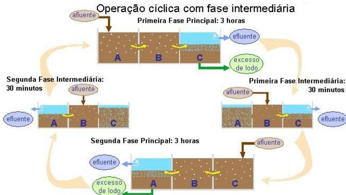
Figura 7: Esquema de Operação Cíclica do SBR (*Sequencing Batch Reactor*)
