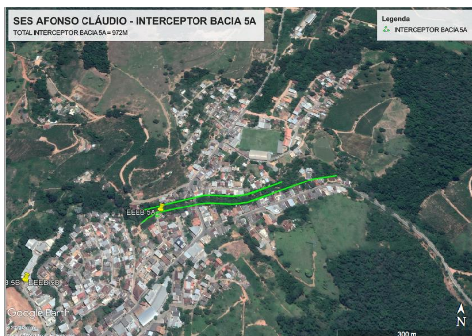
Figura 3: Interceptora Bacia 5A - 577 m enterrado e 395 aéreo
